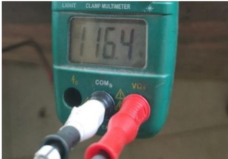
Figura 3. Detalle de lectura instantánea con pinza voltiamperimétrica.
